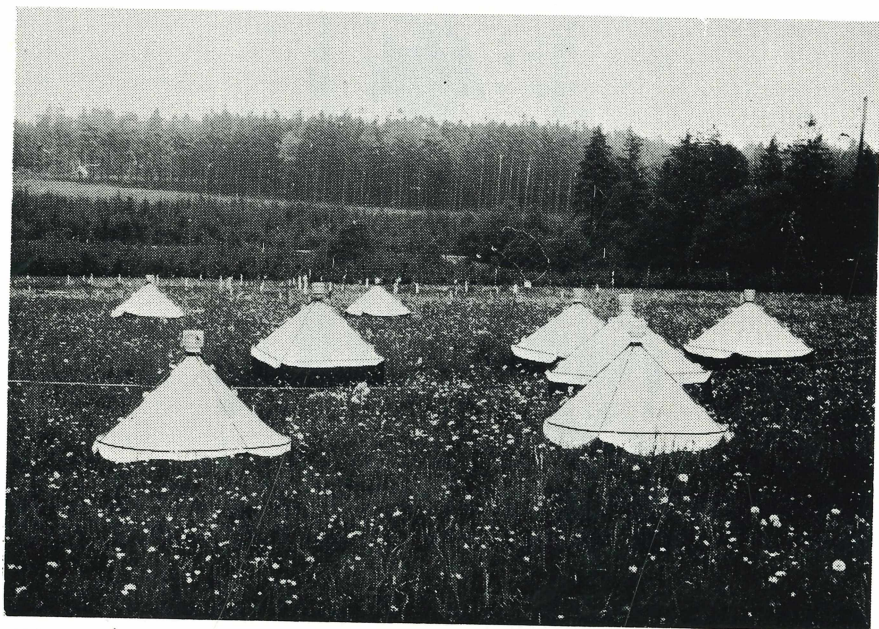
Abb. 3. Boden-Photoelektoren auf einer Mähwiese im Solling (runde Form; umgrenzte Fläche je 1 \text{ m}^2 ).
